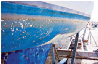
Verfblaasjes en omhooggetrokken verf
