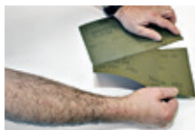
Schleifpapier dem Schleifblock anpassen
