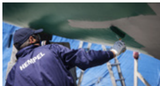
Auftragen von Antifouling auf Primer oder Haftgrund
